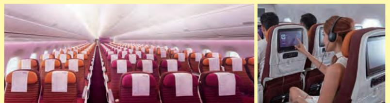
横3-3-3の配列で、シートピッチは32インチ(約81cm)、シート幅は18インチ(約46cm)120°のリクライニングシートを採用
